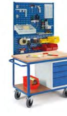
Werkstattwagen mit Schubladenschrank 2x Lochplatten 1x Schlitzplatte
