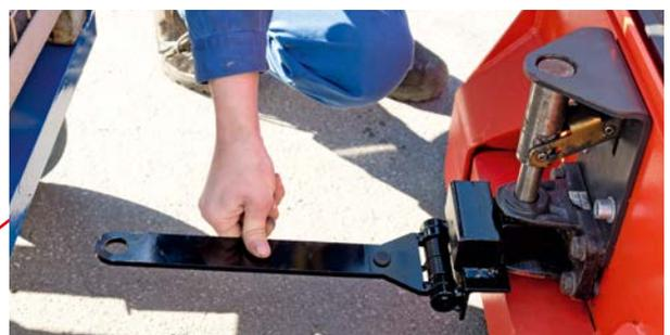
**i** Das Zugfahrzeug muss über eine Frontlenkung und Routenzugdeichsel verfügen, um eine bestmögliche Spurtreue zu gewährleisten.
